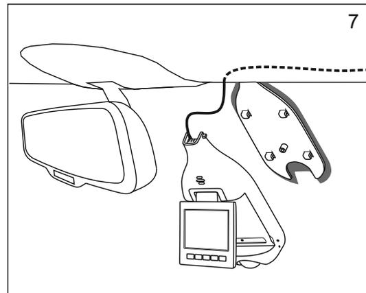
7. Зафиксируйте устройство на держателе с помощью крепежного винта из комплекта поставки (Рис. 8). Восстановите соединение минусовой клеммы с аккумулятором автомобиля.
