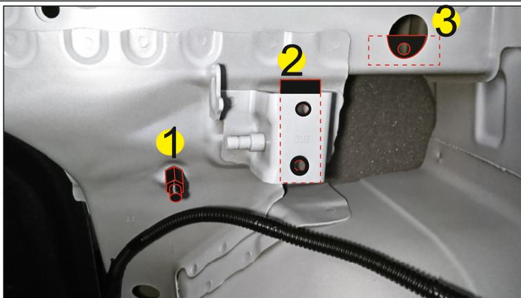
17. Установите детали 1, 2 и 3 на перегородку багажного отсека для фиксации кронштейна из комплекта поставки.
