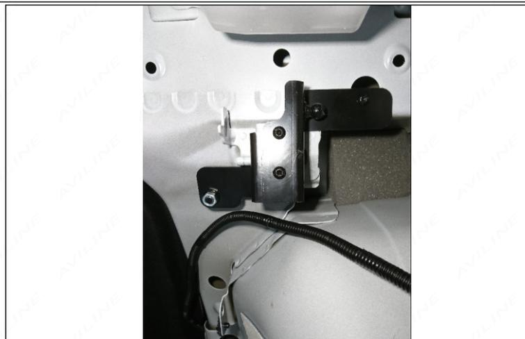
18. Зафиксируйте кронштейн с шарообразным элементом при помощи ранее установленных деталей и крепежа из комплекта поставки.
