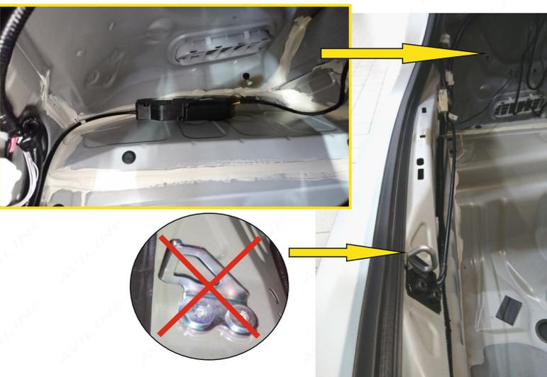
20. Взамен штатной петли замка багажника, установите моторизованную петлю плавного закрытия из комплекта поставки.
