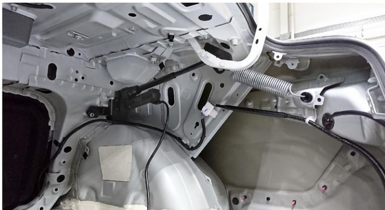
19. Присоедините электропривод к установленным шарообразным кронштейнам **ВАЖНО!** Убедитесь в надежной фиксации шаровых соединений электроприводов с кронштейнами. Проверьте плавность хода, для чего произведите закрытие и открытие крышки багажника вручную.
