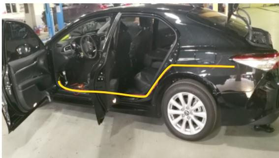
24. Демонтируйте декоративные обшивки порогов водительской стороны салона а/м. Уложите питающий кабель вдоль штатной проводки а/м в направлении места водителя, фиксируя пластиковыми стяжками по всей длине кабеля с промежутками 150-200 мм.
